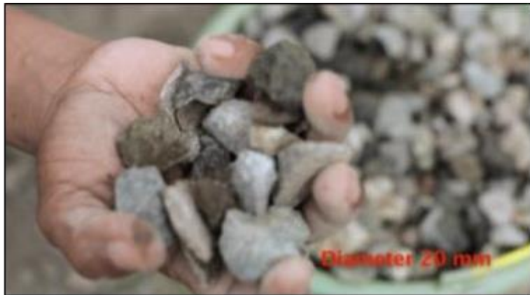
Gambar 5. Diameter Kerikil Yang Baik Untuk Campuran Beton
