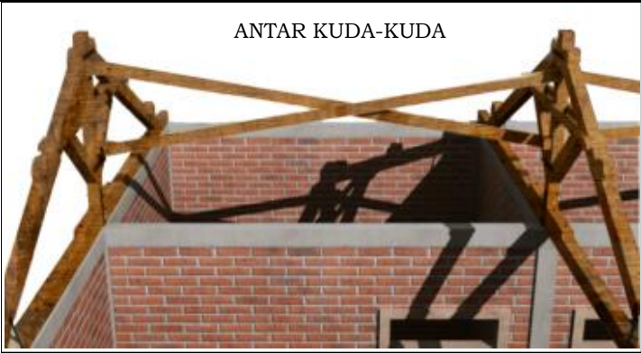
Gambar 34. Ikatan Angin Sebagai Pengikat Antar Kuda-Kuda Kayu
