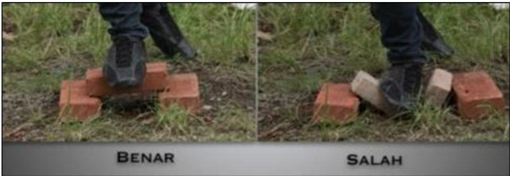
Gambar 13. Pengujian Sederhana Kekuatan Batu Bata
