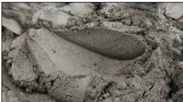
Gambar 9. Hasil Pencampuran Mortar Yang Baik
